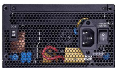
本体の「ECO」スイッチにより、常時回転＆温度に応じて回転数を変える「Auto」、そして一定温度に達するまでファンが回転しない「セミファンレス」を切り替え可能です。
